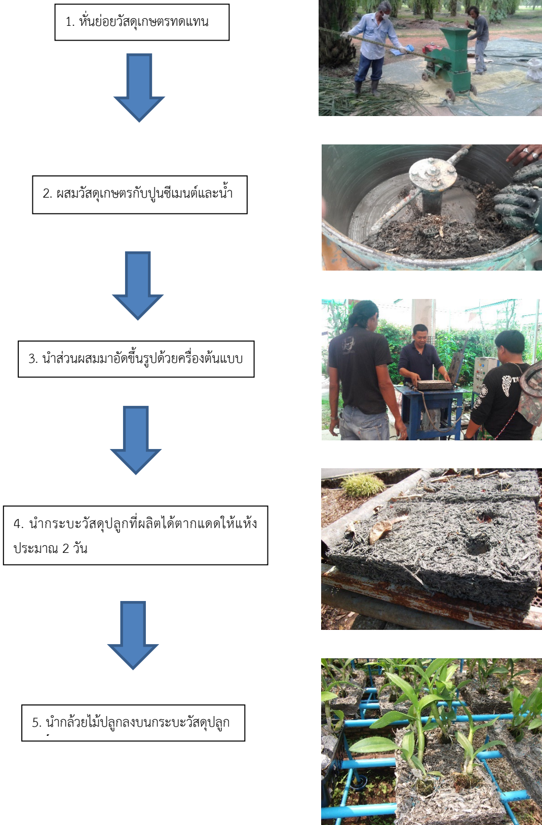
รูปที่ 12 ขั้นตอนกระบวนการผลิตกระบะวัสดุปลูกทดแทน
