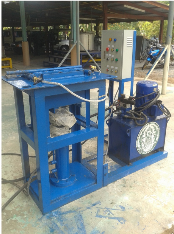
รูปที่ 9 เครื่องผลิตกระบะวัสดุปลูกกล้วยไม้ต้นแบบ
