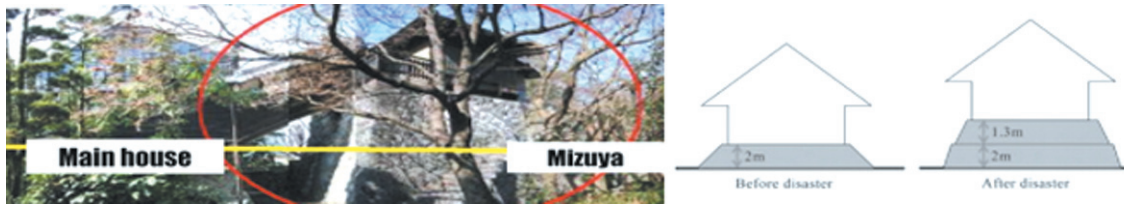
รูปที่ 8 เปรียบเทียบระดับความสูงระหว่างบ้านหน้าและบ้านปกติ ที่มา : Disaster Reduction Hyperbase: online
