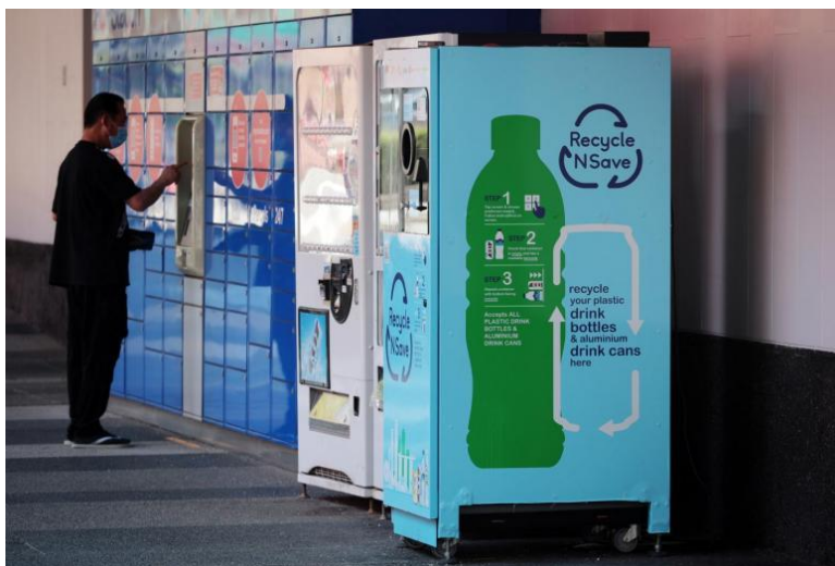
รูปที่ 2 ตู้รับคืนบรรจุภัณฑ์เครื่องดื่มประเภทขวดพลาสติก PET และกระป๋องอะลูมิเนียมภายใต้โครงการ Recycle N Save
