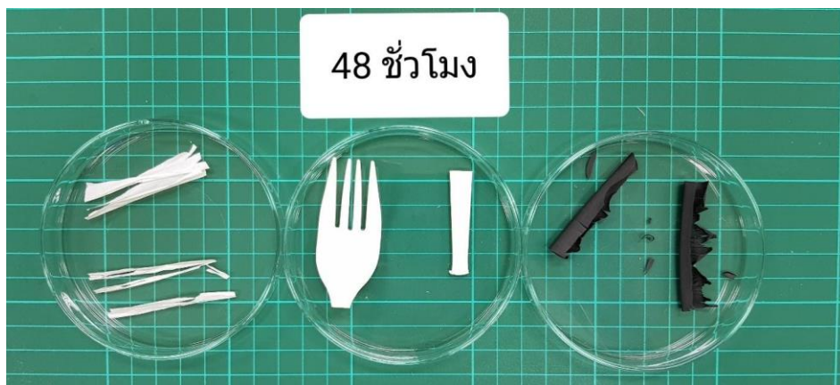
ภาพที่ 3 ชิ้นงานหลังจากฉายรังสี UV เป็นระยะเวลา 48 ชั่วโมง
