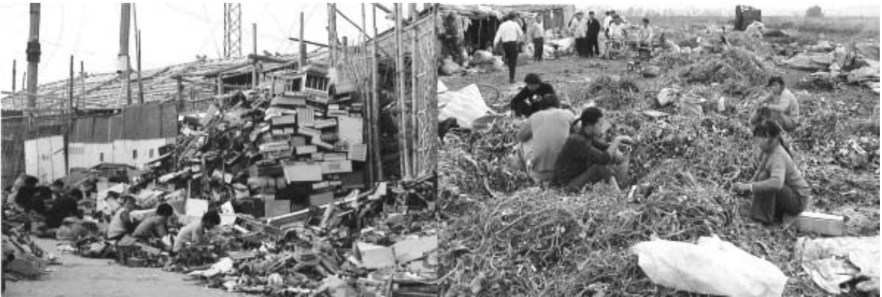
ก) คนงานกำลังแยกชิ้นส่วนขยะอิเล็กทรอนิกส์ ข) การแยกสายไฟเพื่อปลอกหรือเผาให้ได้ทองแดง
